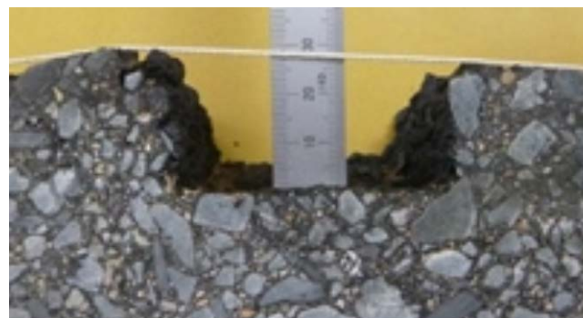
3層供試体によるWT試験後の状況 (左：コンテナファルトスーパー 右：ポリマー改質Ⅱ型)
