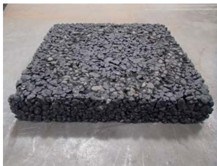
ねじり骨材飛散試験(120分)後の状況 (左：ケミファルトMX 右：ポリマー改質H型)
