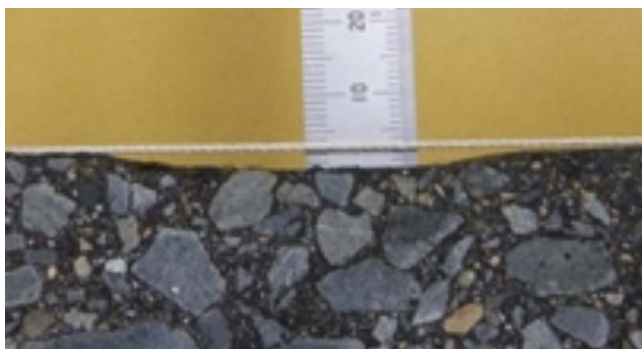
3層供試体によるWT試験後の状況 (左：コンテナファルトスーパー 右：ポリマー改質Ⅱ型)
