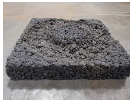
ねじり骨材飛散試験(120分)後の状況 (左：ケミファルトMX 右：ポリマー改質H型)
