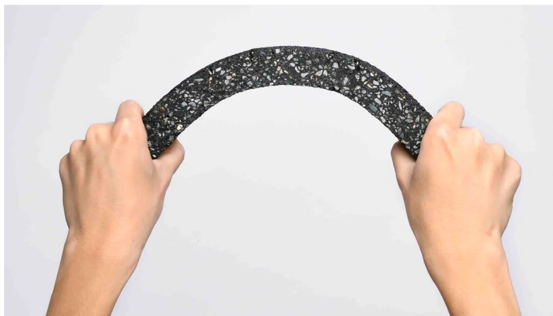
アスファルト舗装の長寿命化に寄与する改質アスファルト「スーパーシナヤカファルト」(写真:ニチレキ)
