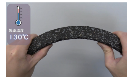
左/アスファルト混合物製造時に必要となる温度を従来品の180℃から130℃に低減することで、CO 2 排出量削減と長寿命化を実現した「スーパーシナヤカファルト」
