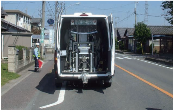
舗装たわみ量測定車(ロメンキャッチャー FWD) 舗装の内部の健全度を非破壊で調査
