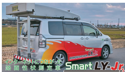
路面性状測定車 (smartロメンキャッチャー LY Jr.)
