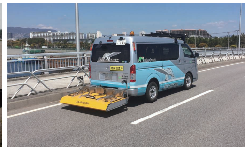
橋梁床版の状況を点検する「smart床版キャッチャー」
