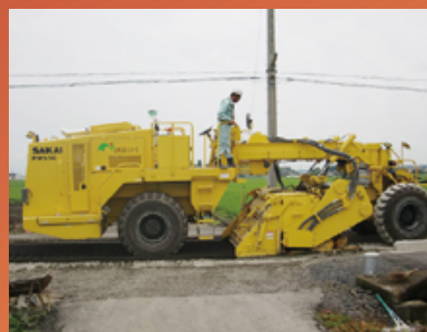
路上路盤再生工法 「スタビセメントRC工法」
