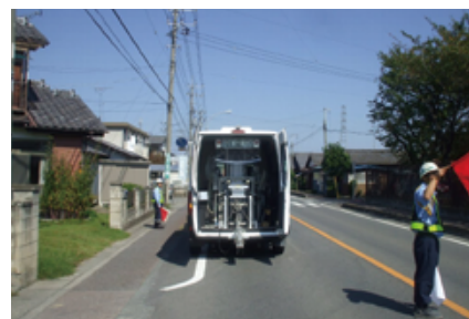
smartロメンキャッチャー FWD (舗装たわみ量測定車)
