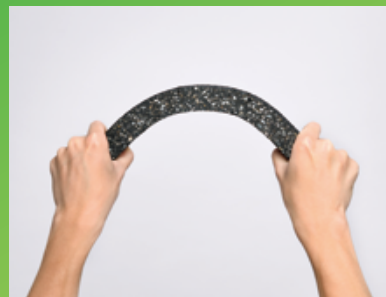
低炭素型長寿命化舗装用改質アスファルト 「スーパーシナヤカファルト」
