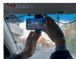
7 スマートフォンによる路面の点検システム「GLOCAL-EYEZ」
