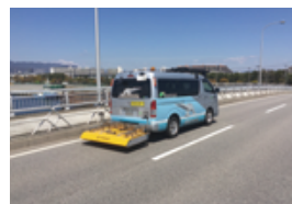
smart床版キャッチャー (DX対応型橋梁床版非破壊調査車)
