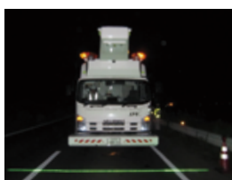
5 路面状態を昼夜問わず点検できる「ロメンキャッチャー LY」
