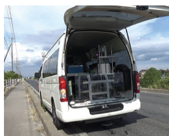
たわみ量計測の様子
