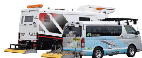
smart床版キャッチャー(橋梁床版非破壊調査車)
