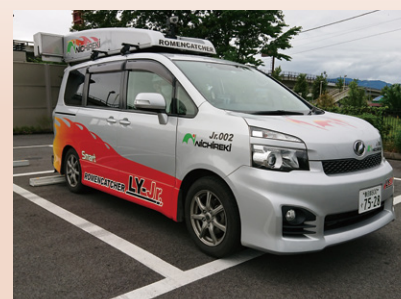
DX対応型路面性状測定車 「smartロメンキャッチャーLY Jr.」
