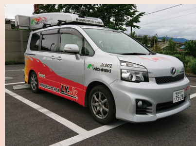
DX対応路面性状測定車 「smartロメンキャッチャーLY Jr.」
