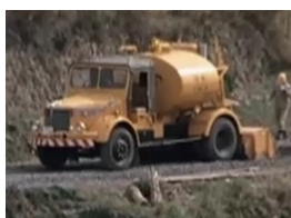
① 路上混合式工法で砂利道を 舗装に変える「カチオゾール」
