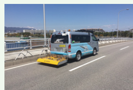
smart床版キャッチャー (DX対応型橋梁床版非破壊調査車)
