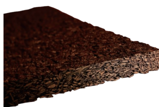
アスウッド舗装
