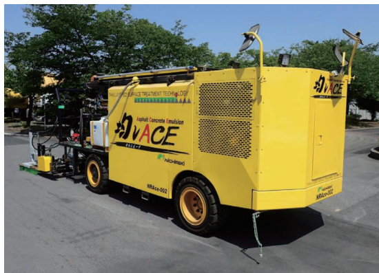
1台で施工が完結できる専用車両
