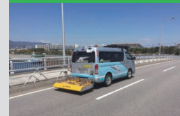
smart床版キャッチャー (橋梁床版非破壊調査車)
