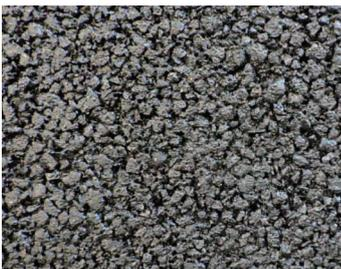
小粒径ポーラスアスファルト混合物(5)
