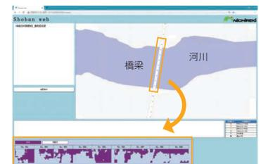
紫は橋梁床版が損傷している箇所を示す
