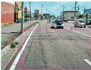
パトロール車に搭載されたカメラが撮影した画像をAIが画像解析し、点検箇所を自動検出する。AIの画像解析により、道路のひび割れや区画線のかすれなどの問題を自動検出する。
