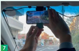
7 スマートフォンによる道路点検システム「GLOCAL-EYEZ」
