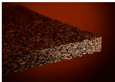
アスウッド舗装
